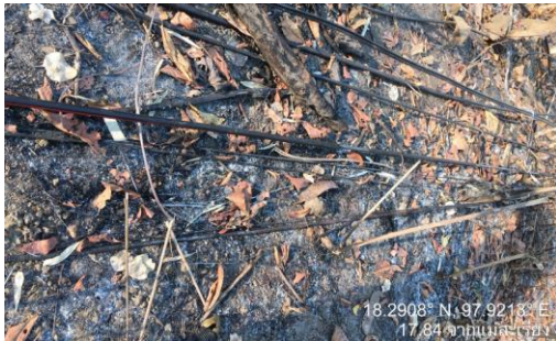
รูปที่ 8 สภาพความเสียหายของเคเบิลใยนำแสงจากไฟไหม้
