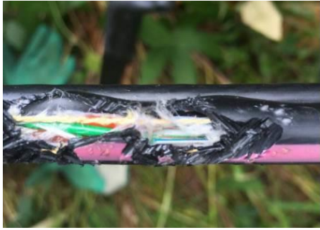
รูปที่ 1 ความเสียหายของเคเบิลใยนำแสงจากสัตว์กัดแทะ
