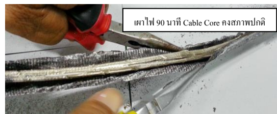
รูปที่ 7 โครงสร้างของเคเบิลใยนำแสงหลังทดสอบการเผาไฟ 90 นาที
